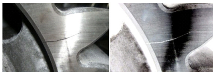
반전 효과를 통해 균열이나 크랙 및 파손 부위를 편리하게 관찰 가능 (모델별 옵션 사양)
